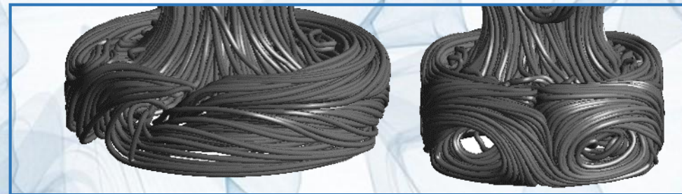
Лінії течії пари в пароприймальній камері з різним виконанням
